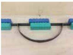
スジ押しは厚紙を使った二つ折り加工などで、折り目に割れが出てしまう時に行う加工です。スジ入れ専用の刃が抜き型に付いていて、型抜き機に通すとしっかり折り目が入ります。弊社では弧のラインのスジ押しも対応しているので、パッケージなどで丸いシルエットを作りたい時にもご利用いただいています!
